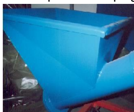
Imaginea 3.2: Este interzisă atingerea interiorului buncărului cu orice obiect.
